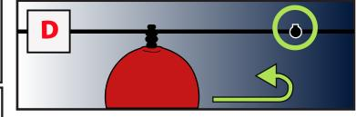
THE BALLOON REVERSES DIRECTION WHEN CONTACTING THE ADJUSTABLE CABLE CLIPS
